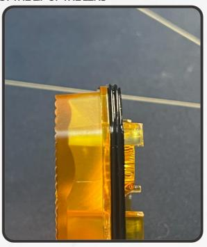
5. INSTALL THE LENS ONTO THE POD. ALIGN THE LOCATOR PINS ON THE LENS WITH THE CORRESPONDING HOLES ON THE POD'S PCB. MAKE SURE THAT AS YOU PRESS THE LENS DOWN, THE GASKET DOES NOT GET FOLDED OR PINCHED
