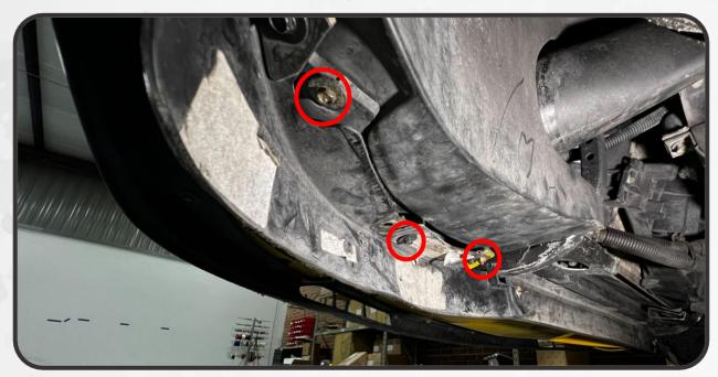
5. WITH THE FENDER LINER REMOVED, DISCONNECT THE SIDE MARKER LIGHT CONNECTION
